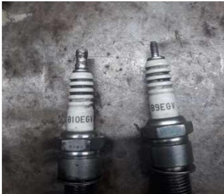
La bujía a utilizar debe mantener las siguientes medidas: rosca 14mm. de diámetro, largo total de la rosca 17.80 mm. (+/- 0.2) con arandela original colocada, arandela de sello original, cantidad una.
